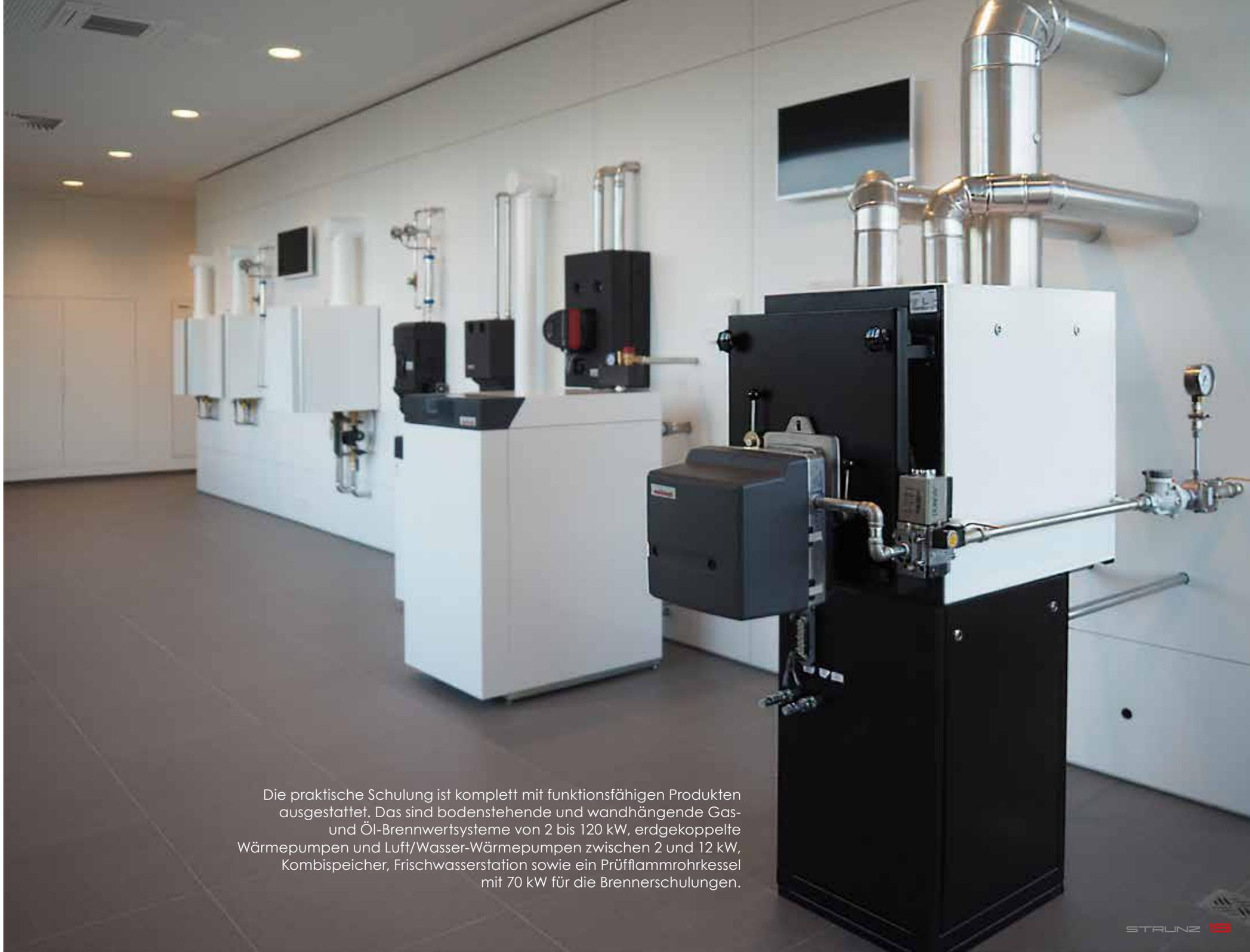
Die praktische Schulung ist komplett mit funktionsfähigen Produkten ausgestattet. Das sind bodenstehende und wandhängende Gas- und Öl-Brennwertsysteme von 2 bis 120 kW, erdgekoppelte Wärmepumpen und Luft/Wasser-Wärmepumpen zwischen 2 und 12 kW, Kombispeicher, Frischwasserstation sowie ein Prüfflammrohrkessel mit 70 kW für die Brennerschulungen.
